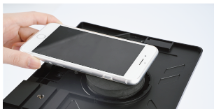
① 手机拍摄请安装82mm镜头环与遮光棉,让手机镜头贴紧遮光棉
